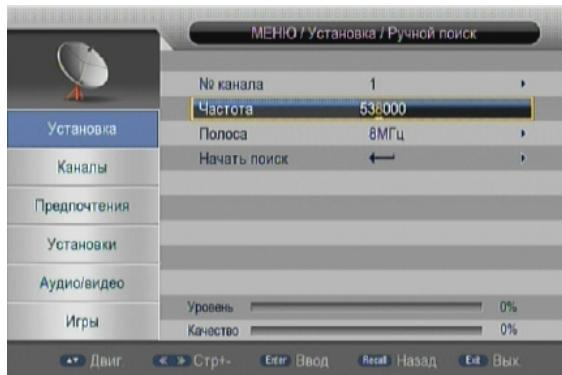
Перед началом ручного поиска нужно ввести значение частоты (в кГц), либо ввести номер канала, частота при этом выставится автоматически.
