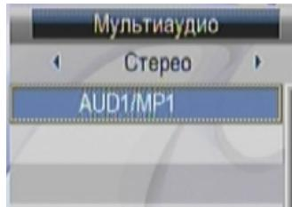
Кроме того, в данном меню можно выбрать стереоканалы, подав один левый канал аудиодорожки на оба выхода (Левый), один правый канал (Правый) на оба выхода либо оба канала на свои выходы (СТЕРЕО). Стереоканалы выбираются кнопками **◀▶**. Предпочтительный язык аудиодорожек устанавливается в меню **ПРЕДПОЧТЕНИЯ**. Там же выбирается язык субтитров.
