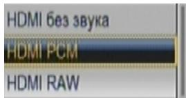
Формат передачи звука через HDMI можно установить PCM или RAW. Также можно вообще выключить звук на HDMI. При этом звук на аналоговом выходе АУДИО останется.
