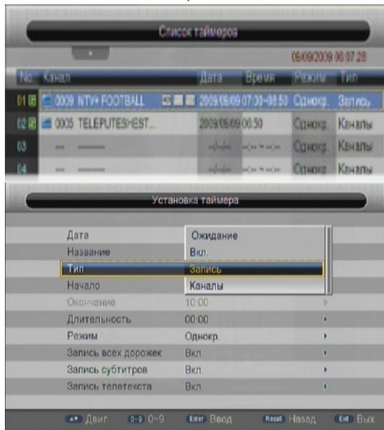
Выход из списка таймеров-кнопкой **ВыХОД**. Любой таймер может быть изменен или отключен в любое время. Для вызова списка таймеров из режима просмотра каналов нужно нажать цветную **СИНЮЮ** кнопку. Затем выбрать нужный таймер кнопками **▼▲** и войти в окно редактирования таймера с помощью цветной **ЖЕЛТОЙ** кнопки. Удалить таймер из списка можно цветной **ЗЕЛЕНОЙ** кнопкой, удалить все таймеры - цветной **КРАСНОЙ** кнопкой. Как вводить цифры, объясняется на стр.18.
