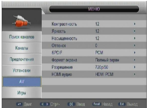
Разрешение изображения устанавливается для видеовыходов HDMI и компонентного YPrPb (для моделей SP1505(T2)C-M).
