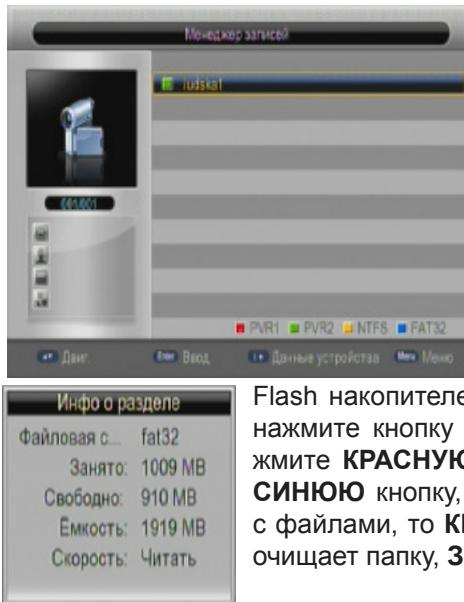
Диск менеджер предназначен для управления разделом USB Flash носителя, его форматирования, а также для копирования/перемещения файлов из одной папки в другую. Для копирования/перемещения файлов нажмите **КРАСНУЮ** кнопку, появятся панели со списками файлов. Следуйте указаниям меню.
