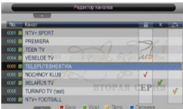
Изменение номера канала. Выбрать канал кнопками ▼▲, нажать **OK**, в поле номера ввести другой номер и зафиксировать кнопкой **OK**.
